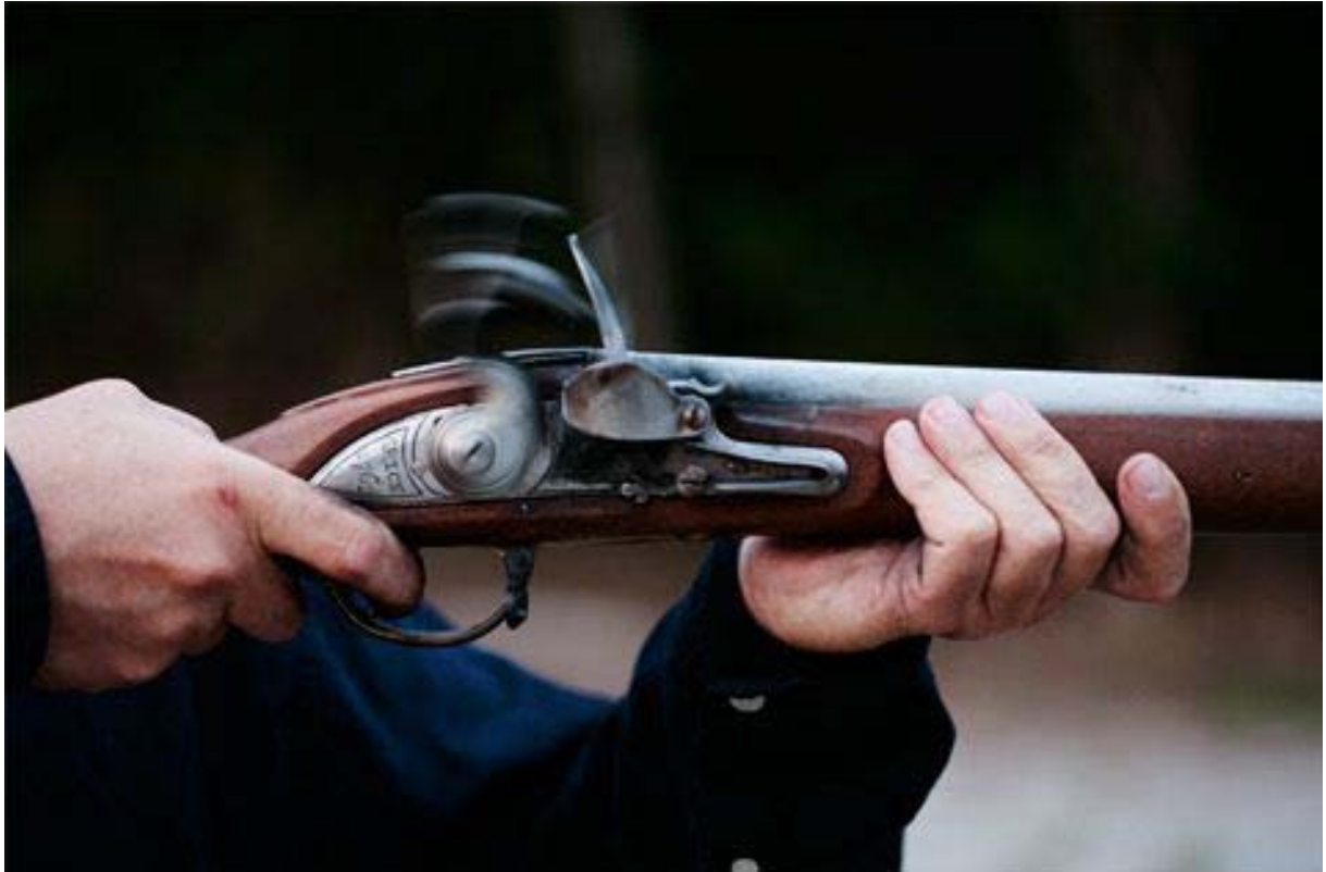
Nach vorne Schnellen des Hahns nach der Betätigung des Abzuges
