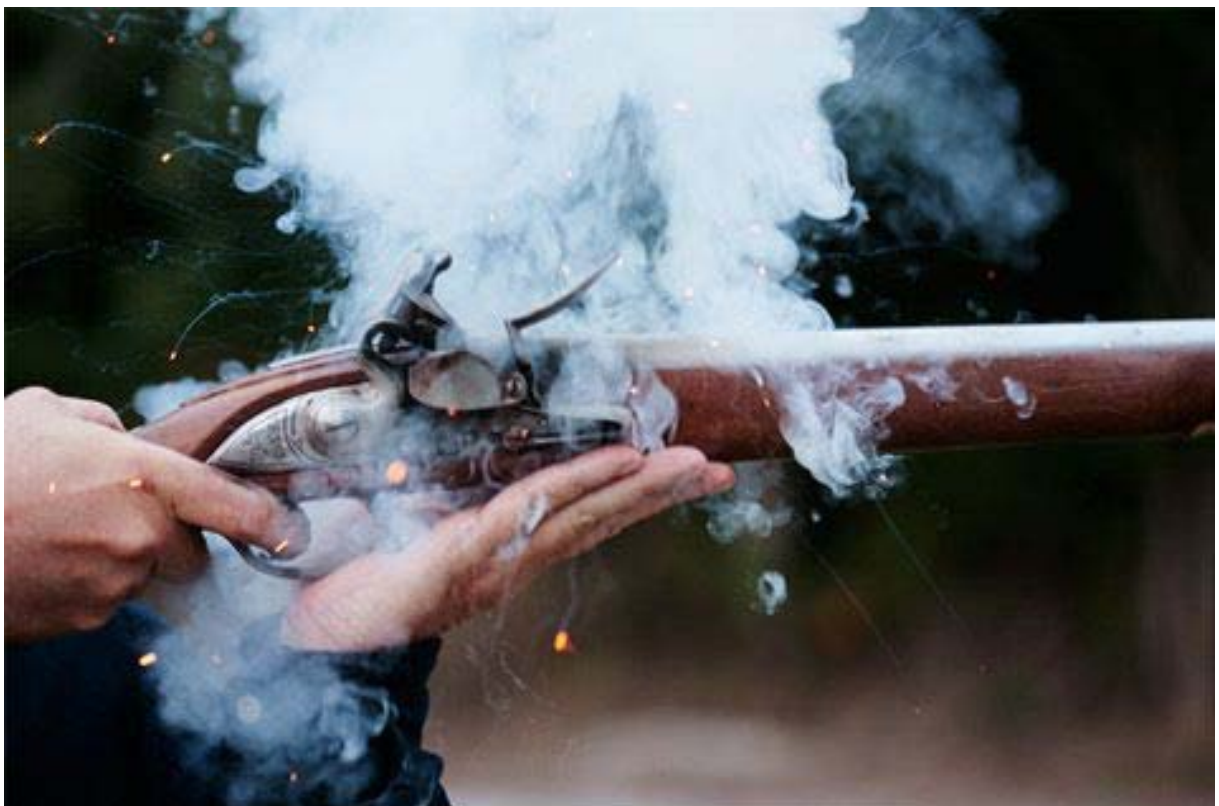
Das aufklappen der Batterie und die dadurch entstandenen Funken können auf die Pulverladung in der Pfanne fallen
