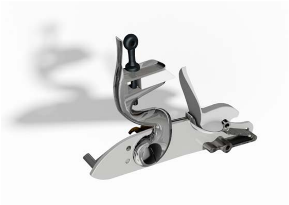
Das Virtuelle 3D-Modell von einem Steinschloss
