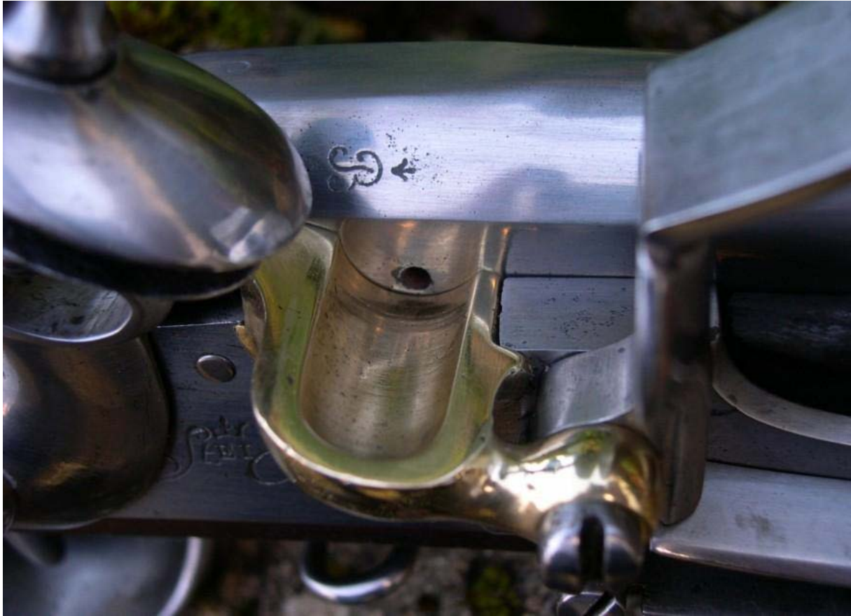
Blick auf einer Pulverpfanne mit Querbohrung zur Ladungskammer
